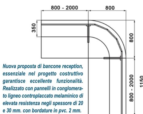
Nuova proposta di bancone reception, essenziale nel progetto costruttivo garantisce eccellente funzionalità. Realizzato con pannelli in conglomerato ligneo controplaccato melaminico di elevata resistenza negli spessori di 20 e 30 mm. con bordature in pvc. 2 mm.
